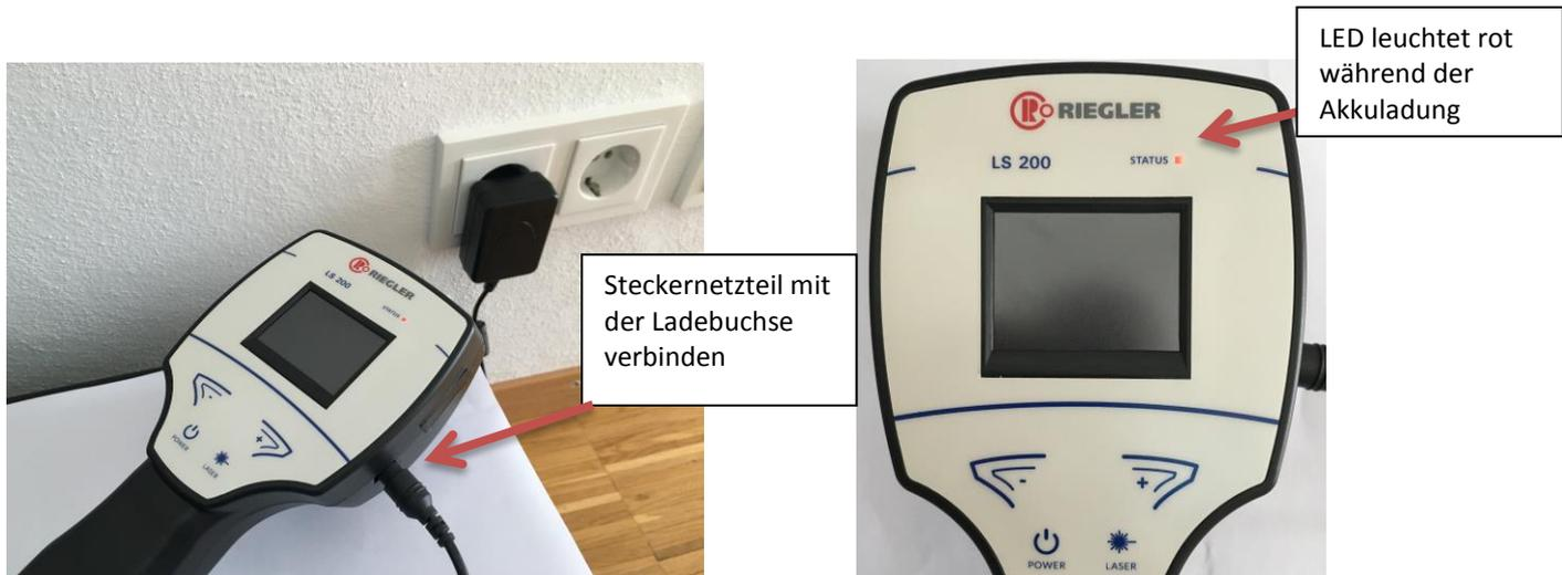
Das LS 200 überprüft den Ladezustand des Akkus und startet den Ladevorgang gegebenenfalls automatisch. Folgende Szenarien sind möglich:
